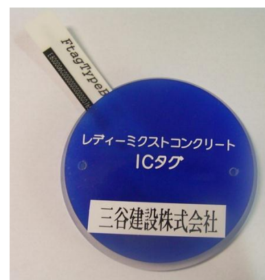
写真－2 保護カバーを取り付けた IC チップ
